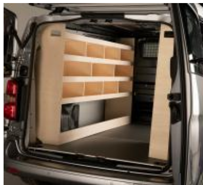
Дървен стелаж Специално проектиран за Proace, дървеният рафт се състои от 4 рафта, 12 отделения плюс горен рафт с пълна дължина. Дървеният рафт е изработен от 15 мм висококачествен европейски шперплат с товароносимост 100 кг.
